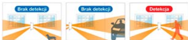
Aktywacja alarmu następuje dopiero wtedy, gdy ruch zostanie wykryty zarówno w górnym, jak i w dolnym obszarze detekcji
